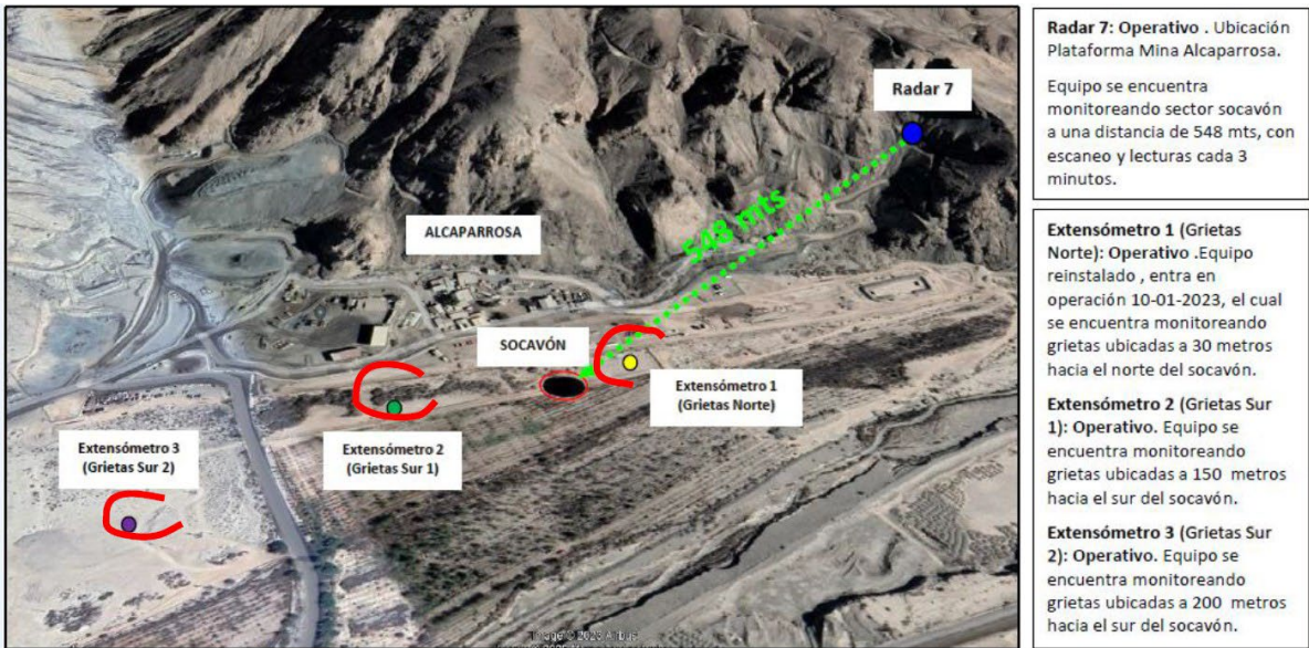
Figura 20. Grietas y métodos de control instalados para su monitoreo.
